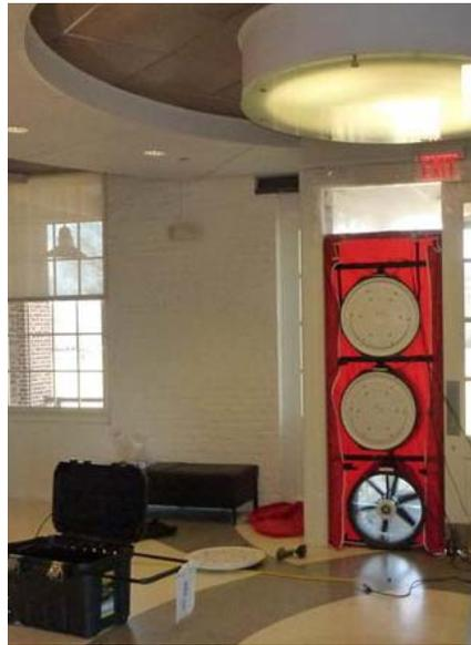
Figure 5.4 Three fan blower door
